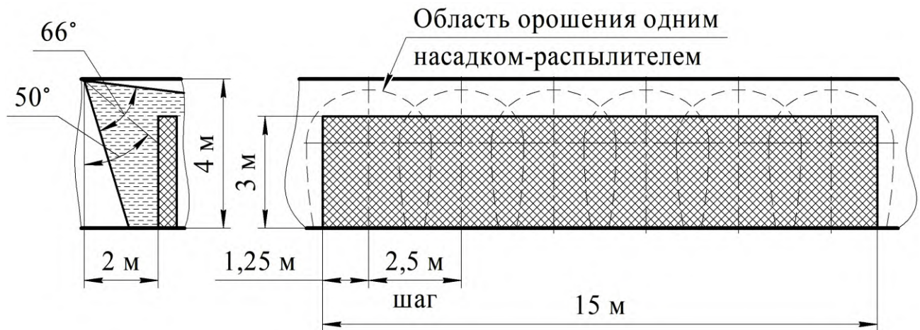
Рисунок 16 – Противопожарная защита боковой поверхности стеллажа 6-ю насадками-распылителями
