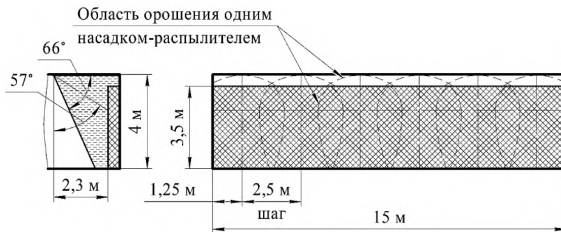
Рисунок Д.5. Противопожарная защита стеллажа 6-ю насадками-распылителями
