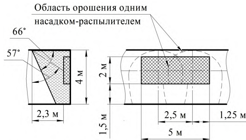
Рисунок 10. Противопожарная защита навесного шкафа 2-мя насадками-распылителями
