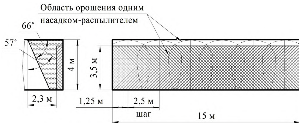
Рисунок 9. Противопожарная защита стеллажа 6-ю насадками-распылителями
