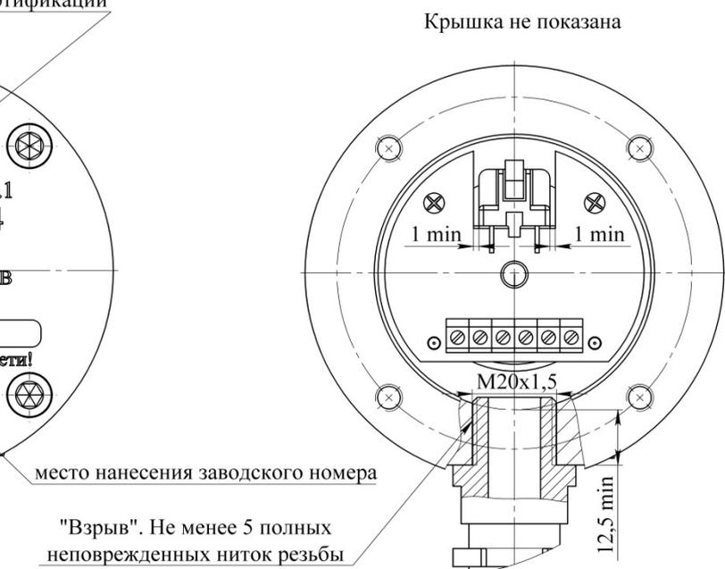
Принцип работы СУЖ основан на изменении диэлектрических свойств среды в зоне электрода при затоплении (или осушении). Контакт жидкости с электродом вызывает изменение в отклике электрического импульсного сигнала на входе электронного модуля СУЖ. В зависимости от уровня сигнала и порога (установленного миниджампером ХРЗ) изменяются состояния светового индикатора и контактов оптронного реле.
